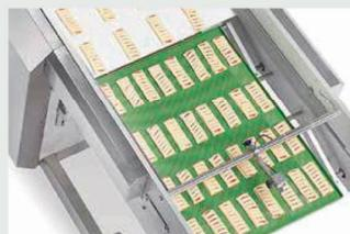
*Opzionale: Impadellamento elettrico con spostamento teglia per doppio scarico prodotti. Velocità e corsa di scarico prodotto programmabili*
